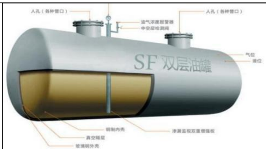
图 2.2-2 SF 双层油罐构造
